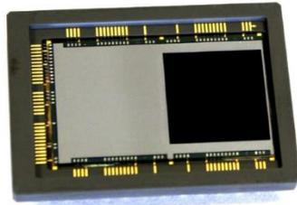
e2v CCD201-20 Electron Multiplying CCD
