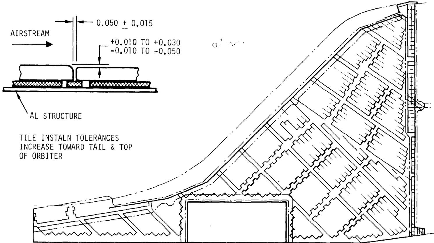
WING LOWER SURFACE TILE GAP ORIENTATION
