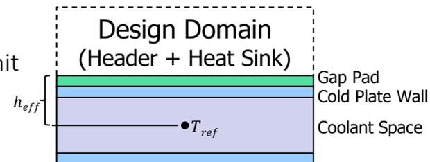
$$T_{ref}(t) = 25 \text{ } ^\circ\text{C} + \frac{(10 \text{ } ^\circ\text{C})t}{1200 \text{ s}}$$
