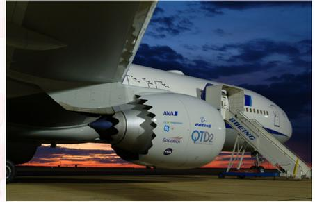
Otra manera que la NASA reduce el ruido en los motores de un jet se muestra en este Boeing 787. Danielle contribuyó en esta investigación. Los cortes de dientes de cierra en la parte trasera del motor, cambian la forma en que la descarga caliente se mezcla con el aire frío del exterior. Esto hace al motor más silencioso.
