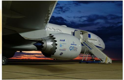
Otra manera que la NASA reduce el ruido en los motores de un jet se muestra en este Boeing 787. Danielle contribuyó en esta investigación. Los cortes de dientes de cierra en la parte trasera del motor, cambia la forma en que la descarga caliente se mezcla con el aire frío del exterior. Esto hace al motor más silencioso.
