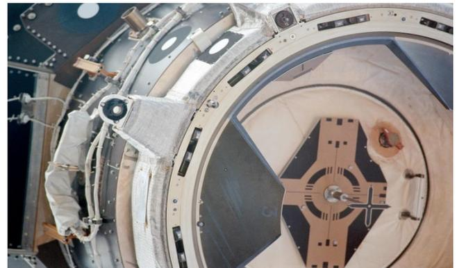
Destino de acoplamiento dentro de uno de los adaptadores de acoplamiento a bordo de la Estación Espacial Internacional
