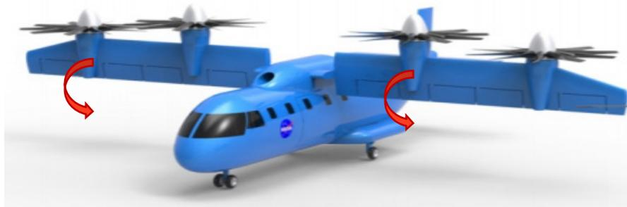
En algunas aeronaves, las aspas de la hélice pueden proporcionar tanto sustentación como empuje hacia delante. Las aspas de la hélice giran en paralelo al suelo para proporcionar sustentación para el despegue, pero las hélices pueden pivotar 90° para que las aspas giren perpendicularmente al suelo para proporcionar empuje hacia delante.
