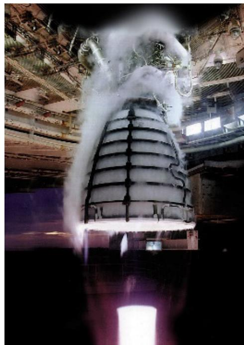
Motor RS-25 sometido a una prueba de fuego en caliente. (NASA)
