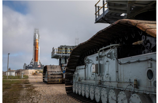
Vista del cohete Artemis I visto desde el pie de la oruga que lo llevó desde el edificio de ensamblaje de vehículos. (NASA)
