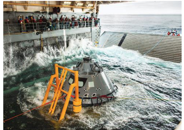
Una versión de prueba de la cápsula Orion se introduce en la cubierta inundada del USS John P. Murtha. (NASA/Tony Gray)
