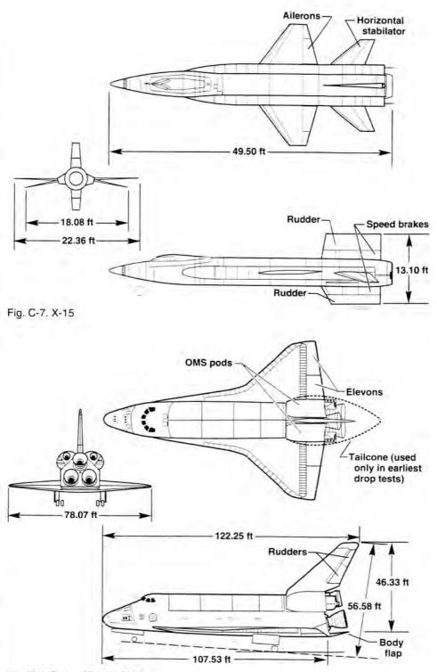
Fig. C-8. Space Shuttle Orbiter
