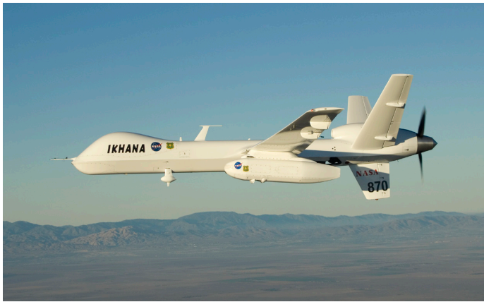
(Izquierda) Con su cápsula de sensores bajo el ala izquierda, el dron Ikhana de la NASA sobrevuela California durante la Misión contra incendios de los Estados Occidentales. (NASA/Jim Ross) (Derecha) Esta imagen del American River Complex fue tomada por el escáner de incendios forestales del Sistema Modular Autónomo de Ikhana en 2008. Esta imagen proporciona información sobre el incendio, el tipo de vegetación y las zonas quemadas. (Google)
