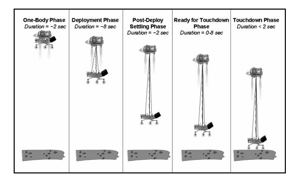
FIGURE 2-4. FINAL LANDING SEQUENCE (SKYCRANE PHASE)
