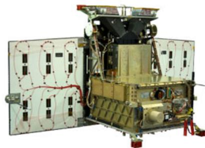
Figure 2.2. The TET-1 bus. Image courtesy of Astro- und Feinwerktechnik Adlershof GmbH (2015).
