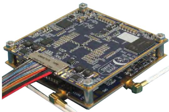
**Figure 17. SWIFT-RelNav Radio Prototype.**
