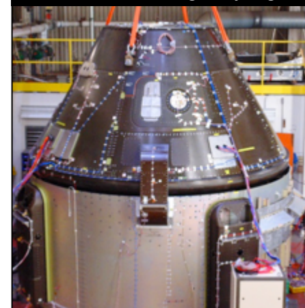
STA in Modal Test Config
