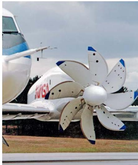
**Figure 4-7.** The propfan on the Gulfstream II. (NASA)
