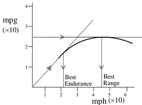
Figure 8.3 Miles per Gallon vs. Miles per Hour
