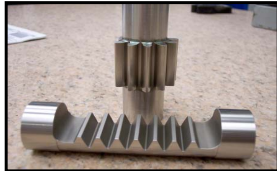
Actuator Rack n' Pinion
